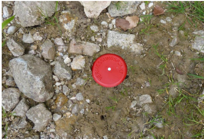
Abbildung 3: Detailaufnahme einer Markierungskappe
